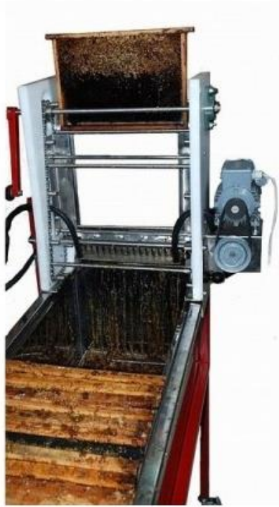
116. kép Félautomata gőzzel fűtött, rezgőkéses fedelezőgép
